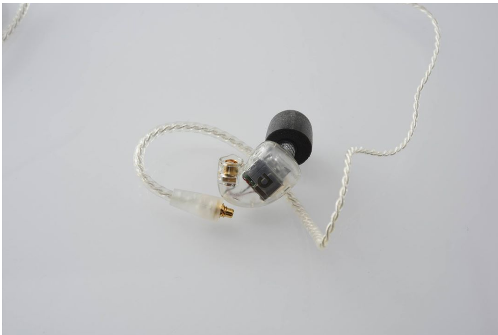
耳機線表層使用INVISTA專利CORDURA纖維作結構性強化
